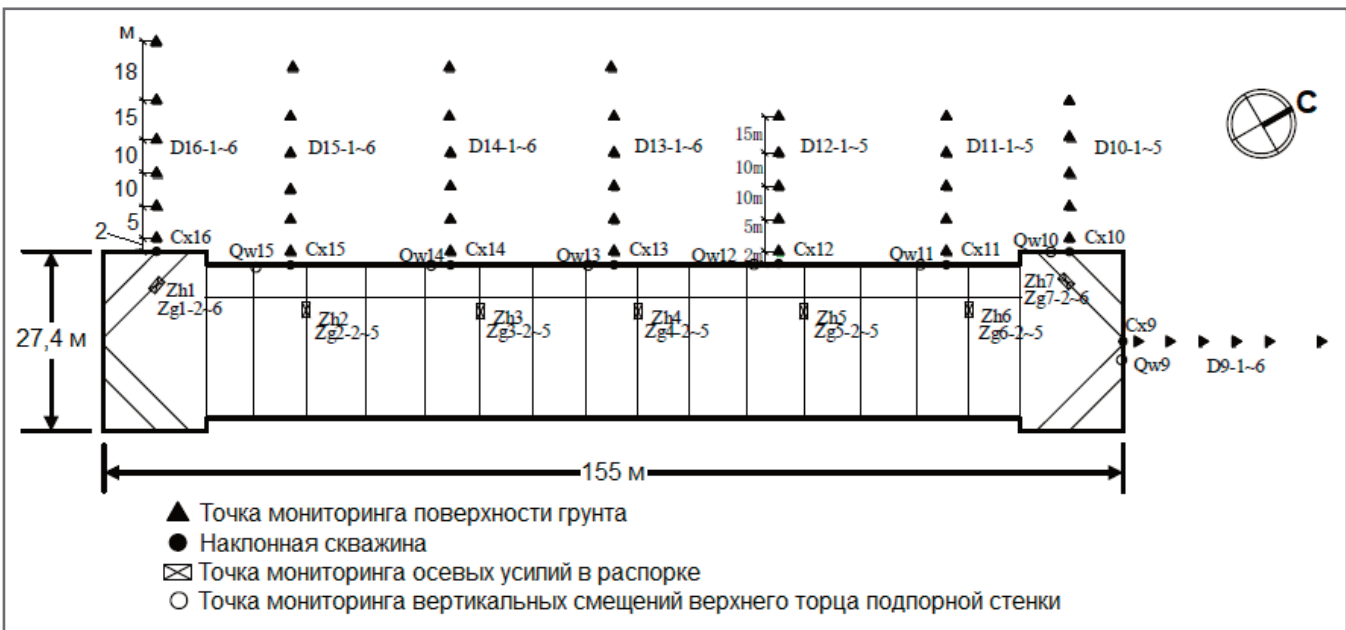
Рис. 4. Схема расположения точек мониторинга поведения котлована А
