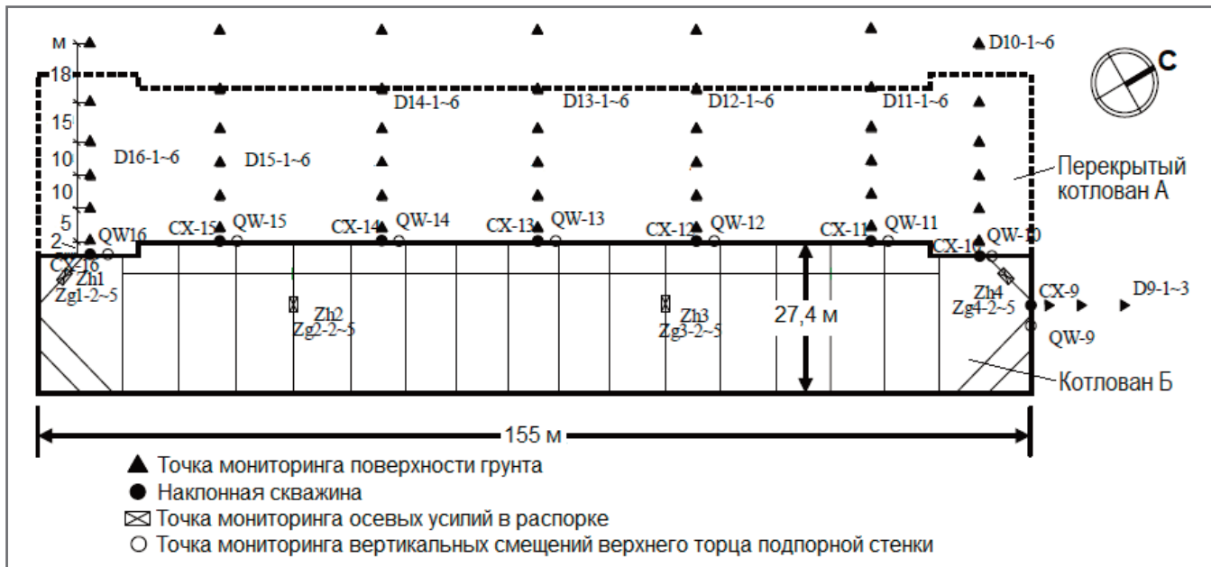
Рис. 5. Схема расположения точек мониторинга поведения котлована Б
