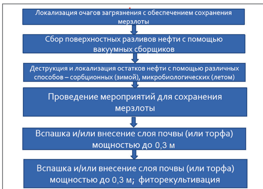
Рис. 2. Рациональная схема ликвидации поверхностных нефтяных загрязнений в криолитозоне [4]
