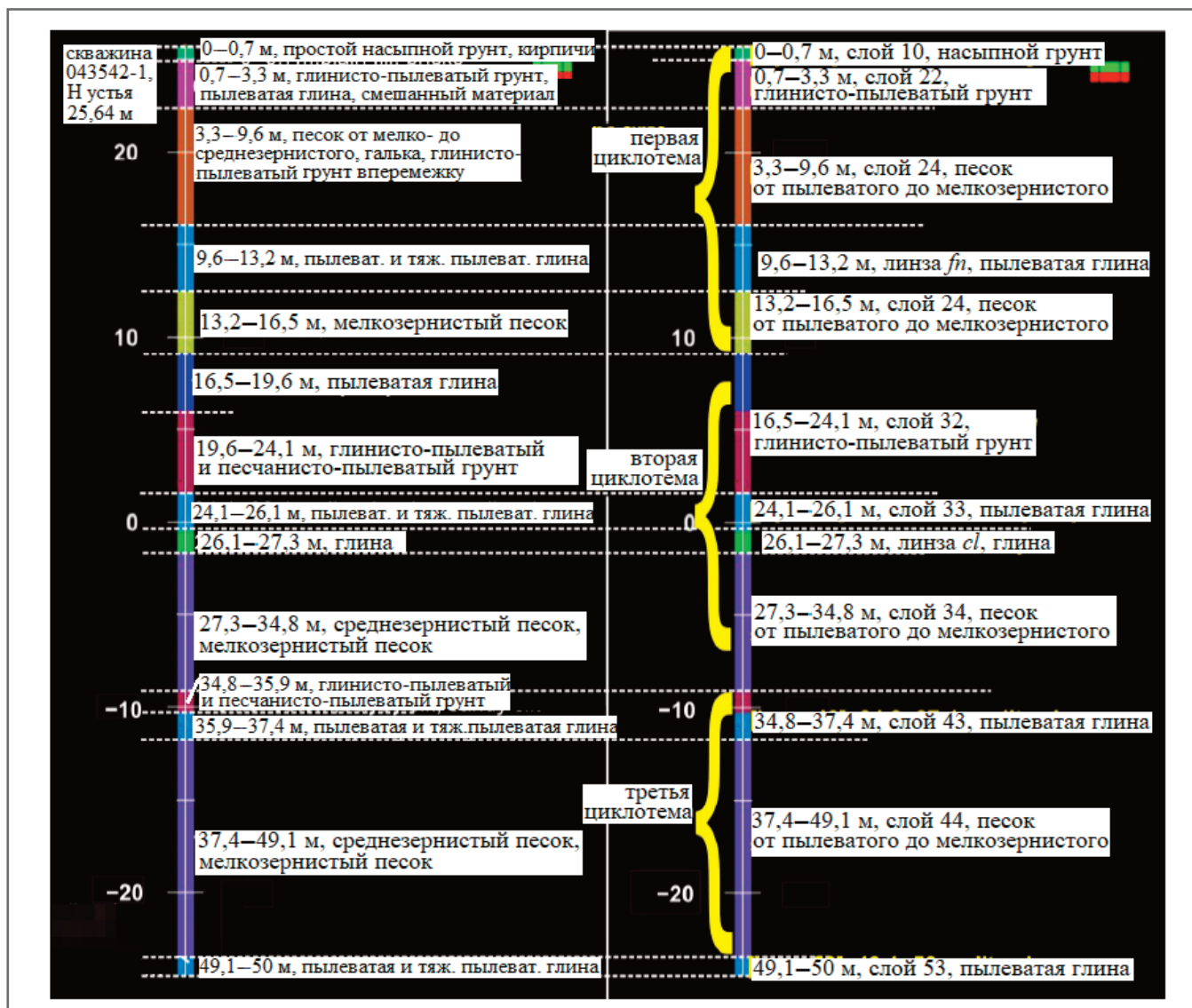
Рис. 4. Литологическое обобщение на примере скважины 043542-1
