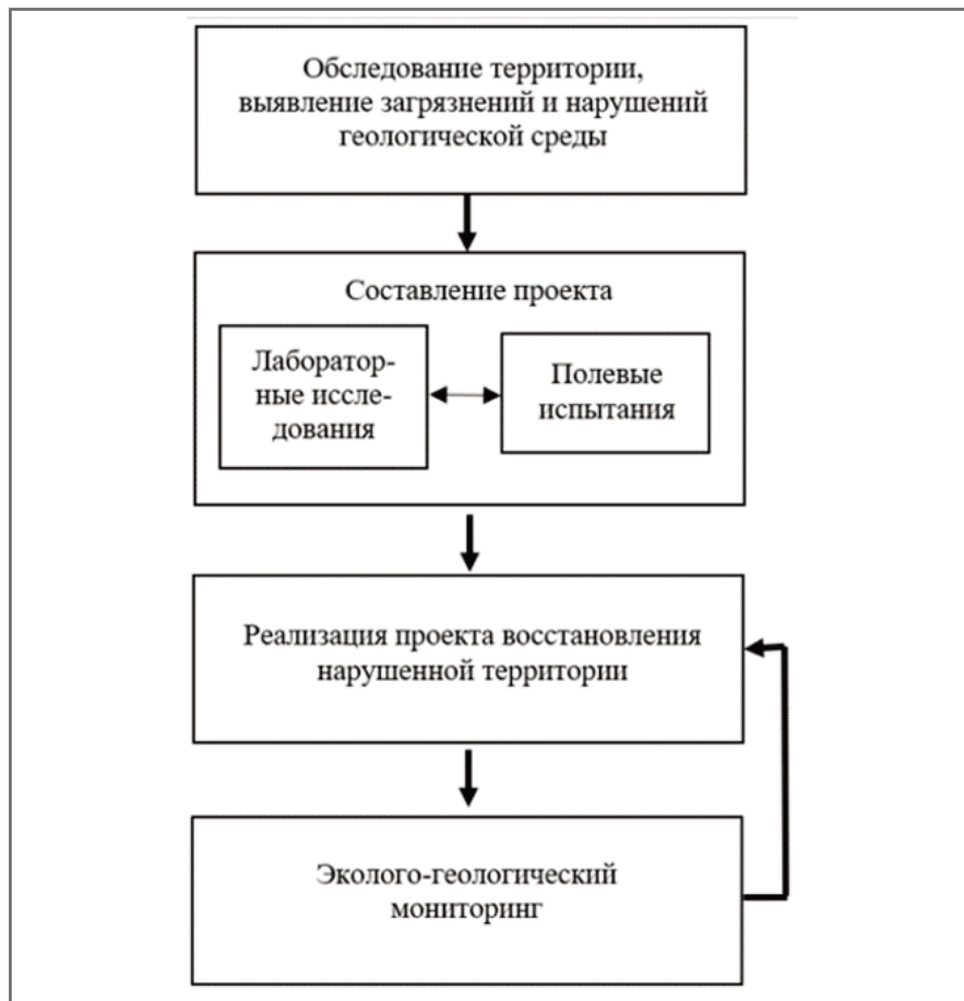
Рис. 4. Последовательность мероприятий по восстановлению техногенно нарушенной геологической среды вдоль трасс нефтепроводов
