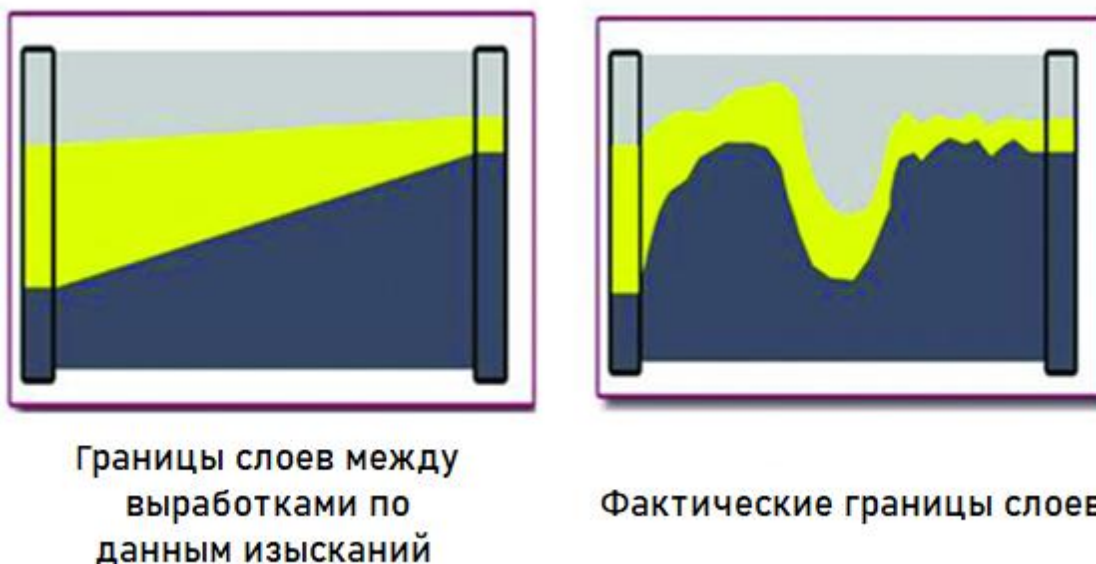
Рис. 3. Пример субъективного отражения границ слоев грунта по данным изысканий на основе информации из горных выработок и возможного несоответствия фактическому напластованию [4]
