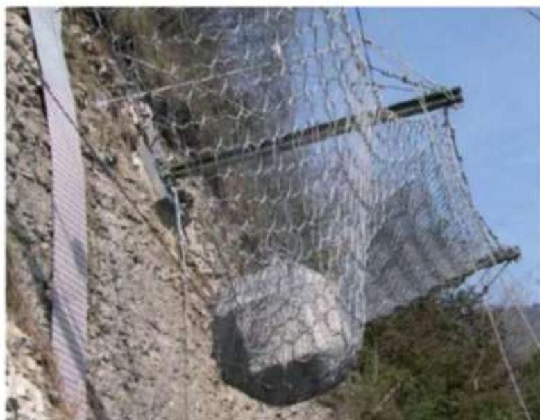
**Рис. 3.** Испытания улавливающего гибкого барьера на удар бетонного блока [2]
