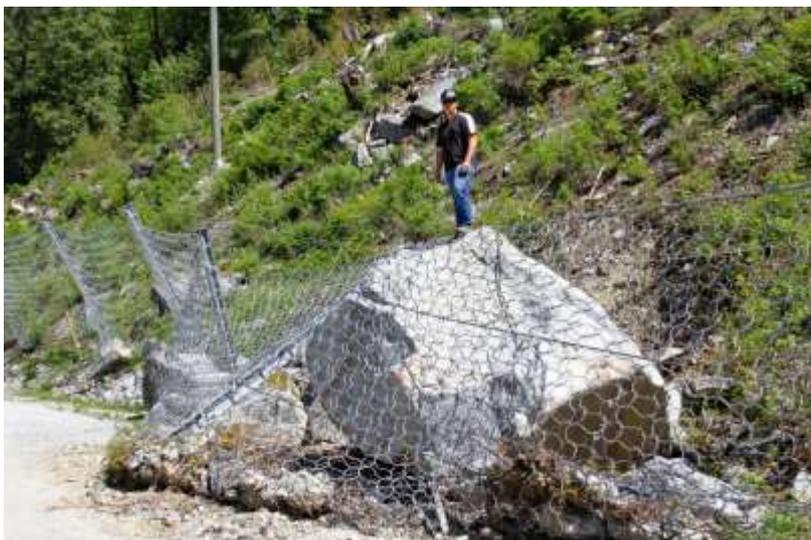
**Рис. 8.** Результат воздействия крупных скальных блоков на гибкий противокамнепадный барьер Trumer в Канаде в 2017 году [6, 7]
