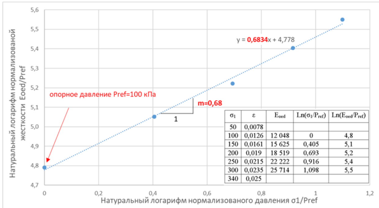
Рис. 15. Использование принципа опорного давления и степенной зависимости
