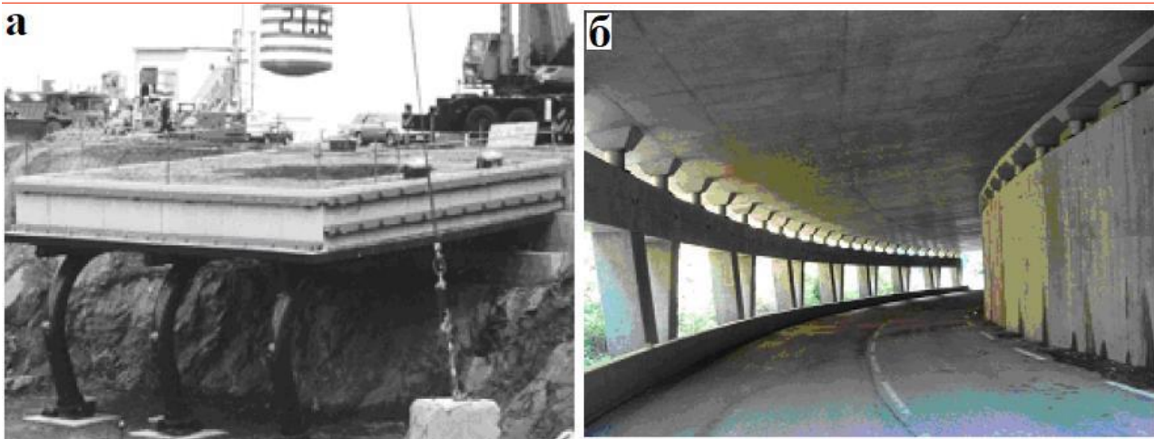
Рис. 12. Полномасштабный эксперимент с падением железобетонного снаряда на композитный сталежелезобетонный противокаменепадный навес (Maegawa et al., 2003) (а) и противокаменепадная галерея с рассеивающей энергию воздействий системой опор в альпийском курортном регионе Валь д'Арли во Франции (Masuya, 2007) (б)
