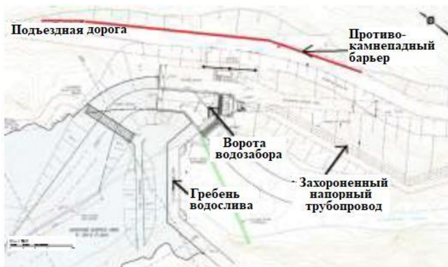
Рис. 7. План водозаборных сооружений и противокаменпадного барьера [1]
