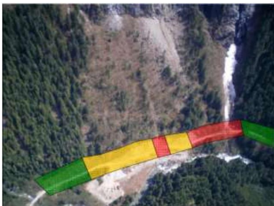
Рис. 4. Участки низкой (зеленый цвет), средней (желтый цвет) и высокой (красный цвет) вероятности негативных последствий от возможных камнепадов во время строительства объектов ГЭС на рассматриваемой территории [1]
