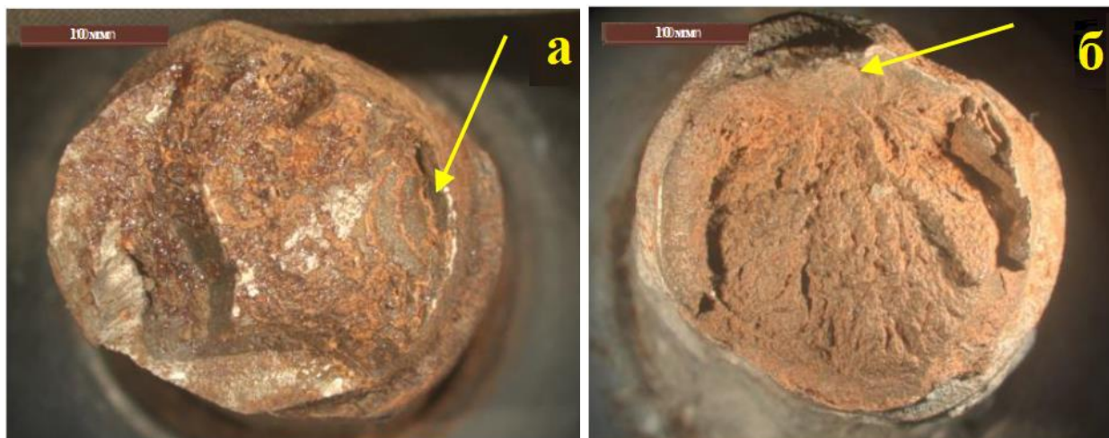
Рис. 7. Разрушение из-за распространения кривой вязкой трещины от впадины резьбы или рифления первоначально под углом 45 град. (на начало разрушения указывает стрелка), а затем – с нерегулярным рельефом поверхности разрушения (образец T2) (а); разрушение в результате распространения поперечной хрупкой трещины с радиальными линиями (образец F9) (б)
