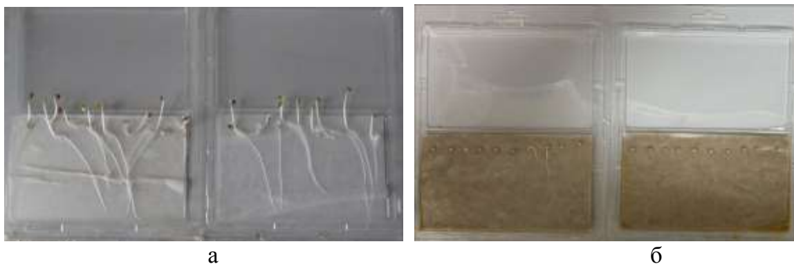
Рис. 7. Варианты фитотестирования с использованием проращивания семян горчицы белой: а – элюатный; б – аппликатный (называемый также контактным или субстратным)
