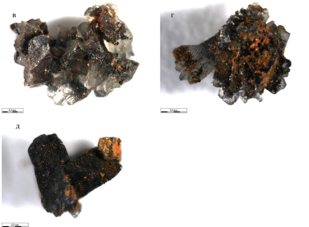
Рис. 2. Техногенные минералы донных отложений колодца вертикального дренажа: а - зерна кальцита с идиоморфными гранями и ступенчатой поверхностью спайности; б - затемненный в центре и прозрачный по краям агрегат кристаллов кальцита; в - агрегат прозрачных зерен кальцита; г - агрегат кристаллов кальцита с налетом гидроксида железа (III) на поверхности; д - срастание зерен кальцита и пирита
