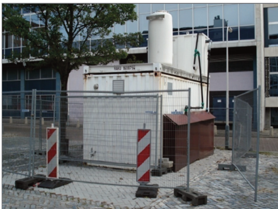
Рис. 14. Общий вид контейнера с электрокинетическим оборудованием для очистки грунтов от нефтепродуктов на городской территории (фото В.А. Королева)
