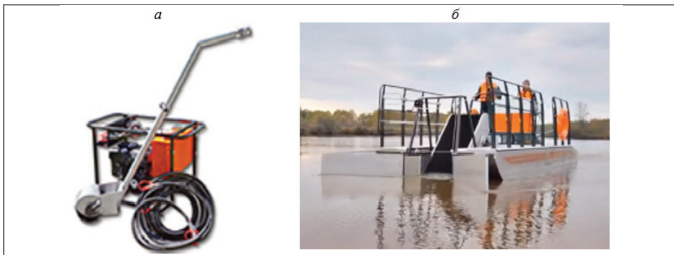
Рис. 9. Ручной щеточный скиммер-нефтеборщик «СОР» (а) и плавающий скиммер-катамаран КН-1 (б) [12]
