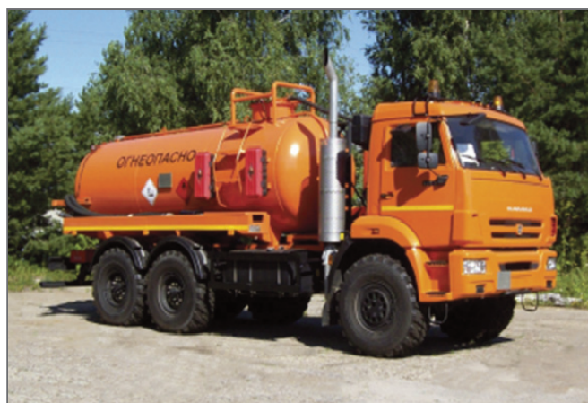
Рис. 8. Вакуумный нефтесборщик АКН-10 [12]
