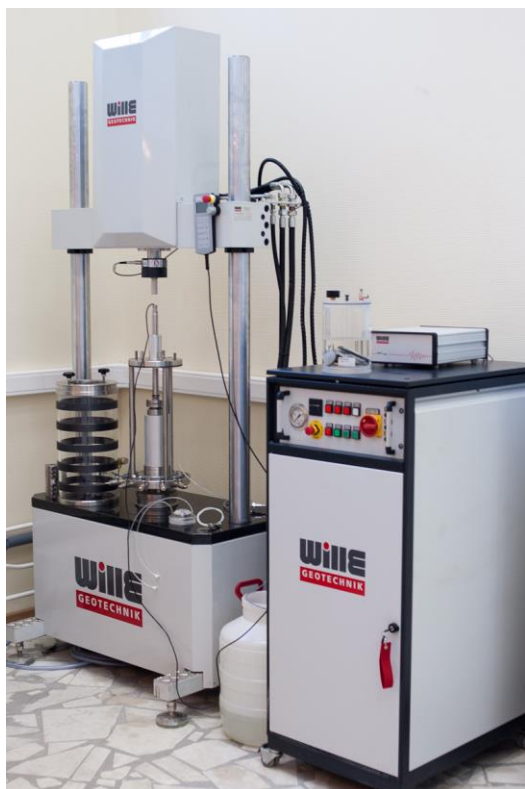
Рис. 1. Общий вид установки трехосного сжатия с возможностью динамического нагружения
