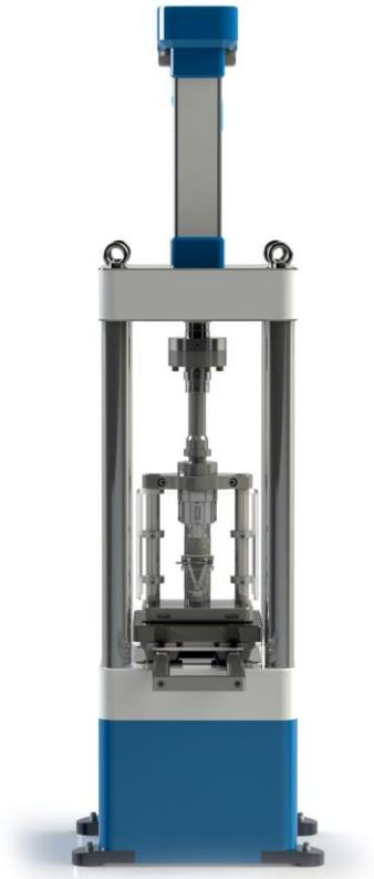
Испытания на одноосное сжатие с технической точки зрения являются наиболее простым из возможных методов определения прочности скальных грунтов. Для проведения опыта достаточно пресса, аналогичного применяемому при испытаниях строительных материалов. Тем не менее, данный опыт позволяет определить значительно большее число параметров, которые могут использоваться при решении прикладных задач.
