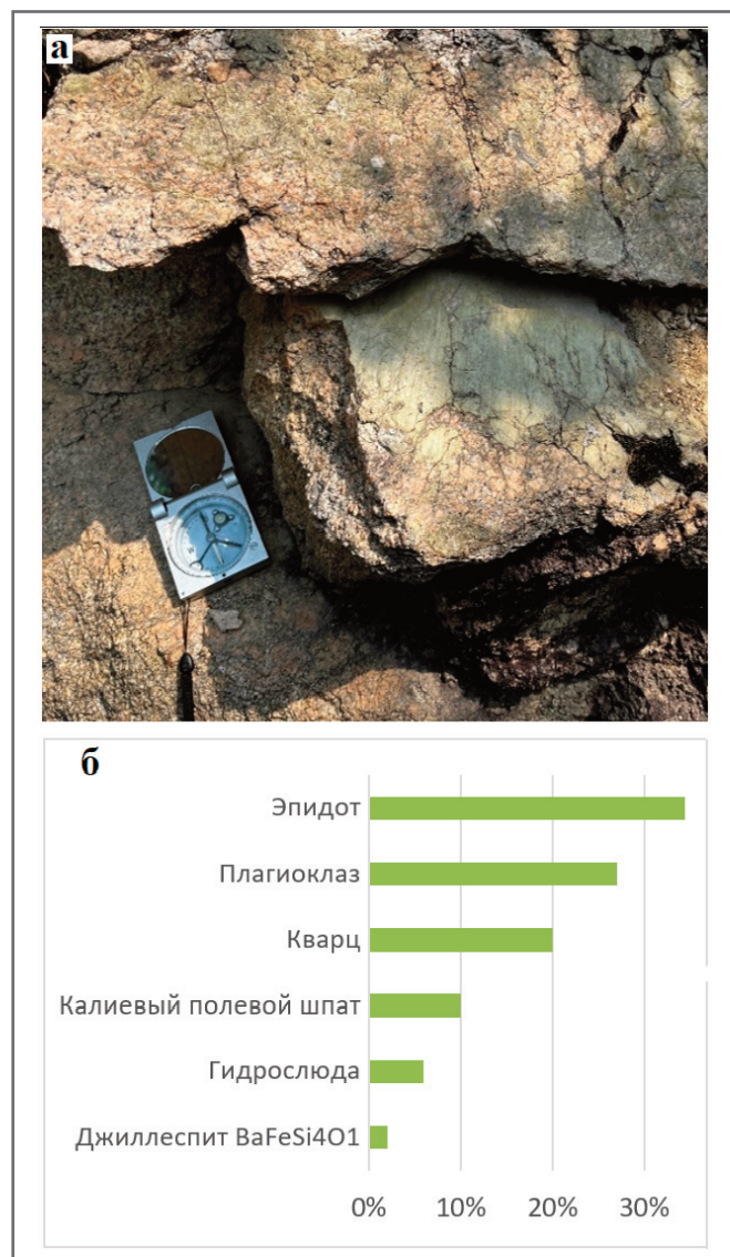
Рис. 7. Плоскость крутопадающих трещин: а – поверхность стенок притертая, с заполнителем и зеркалами скольжения; б – минеральный состав зеленовато-серого заполнителя (выполнено В.Л. Косоруковым)
