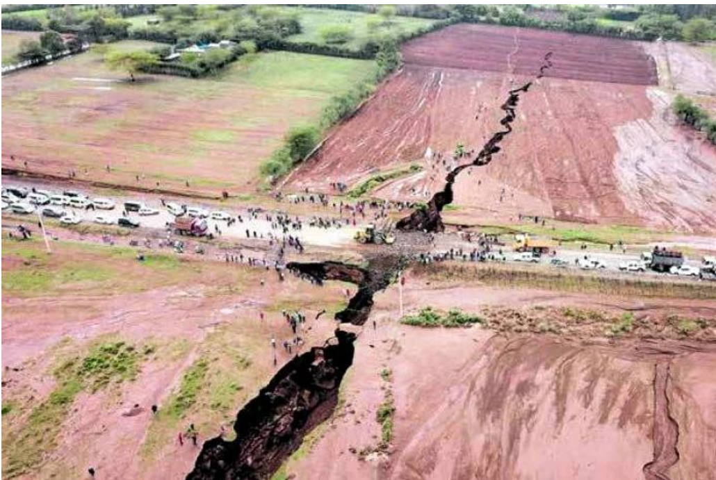
Рис. 5. Фрагмент Восточно-Африканской зоны «живых» разломов (Кения), протянувшихся от устья р. Замбези до залива Акаба в Красном море. В центре кадра разорванная трещиной дорожная трасса. Африканский континент раскалывается у нас на глазах, но как быстро это будет происходить, мы не знаем
