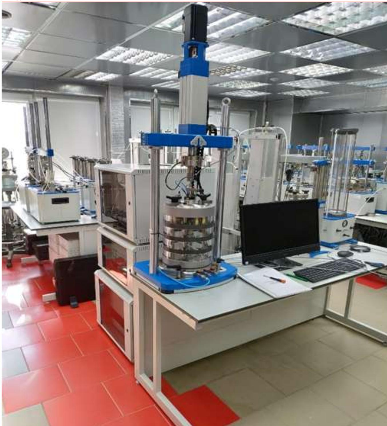
**Рис. 1.** Установки малоамплитудных крутильных колебаний
