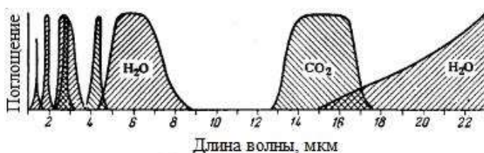
Рис. 10. Основные области поглощения инфракрасных лучей углекислым газом и водяным паром [44]
