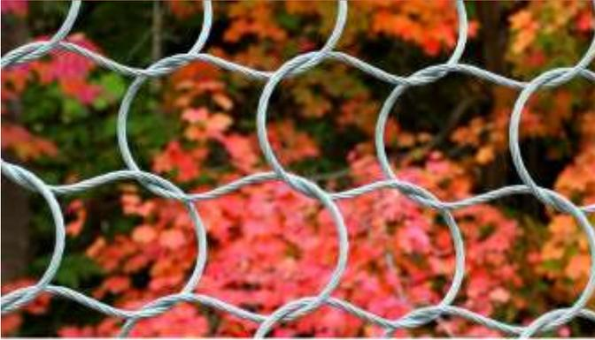
**Рис. 7.** Устройство «омега-сетки» крупным планом [2]
