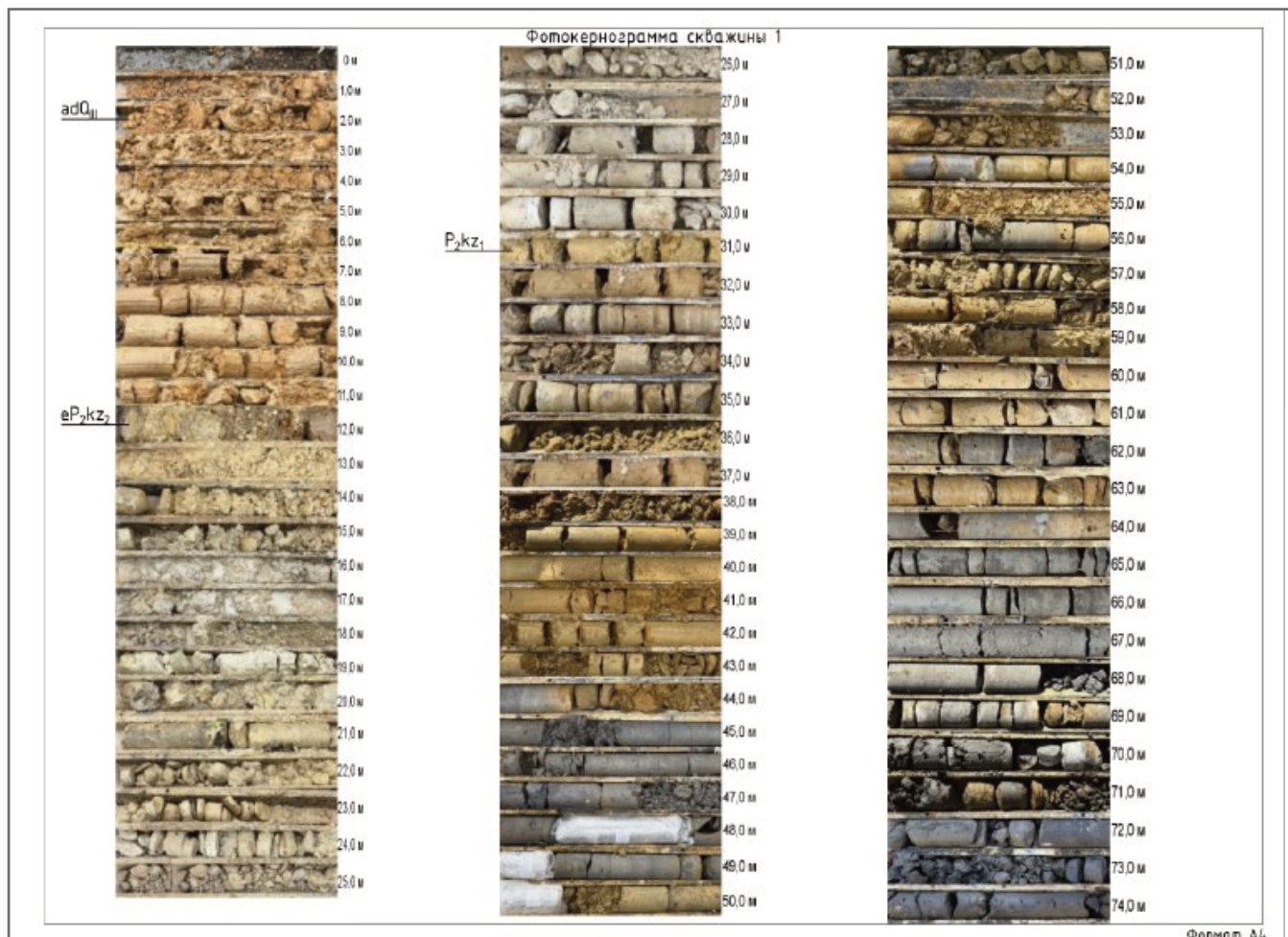
Рис. 3. Фотокернограмма скважины в интервале 38–74 м
