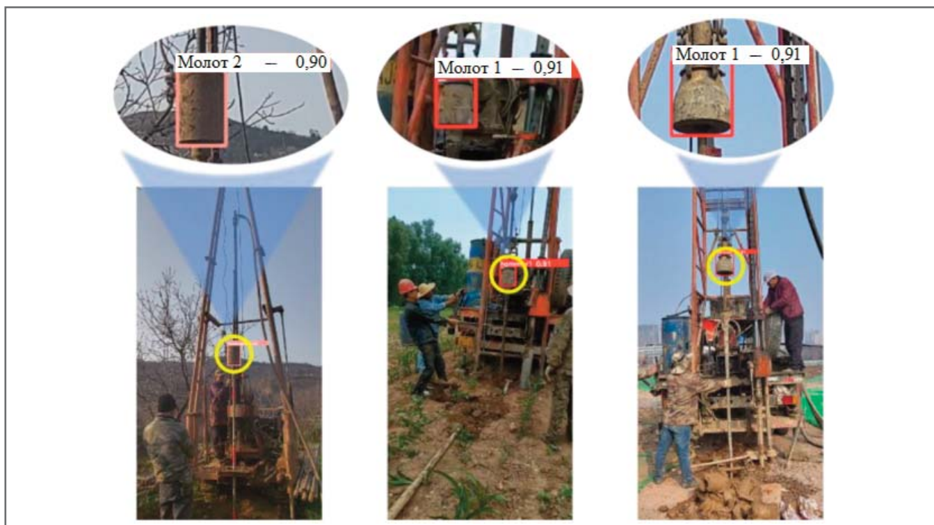
Рис. 4. Примеры результатов детекции молотов. Полученные значения средней точности положительных предсказаний, усредненной по обоим классам молотов ( mAP ), указаны над соответствующими фотографиями, сделанными на площадке испытаний
