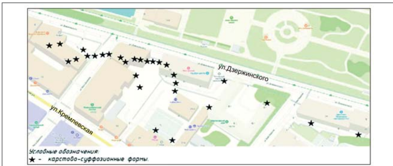
Рис. 1. Схема расположения карстово-суффозионных форм рельефа на участке между улицами Кремлевская и Дзержинского
