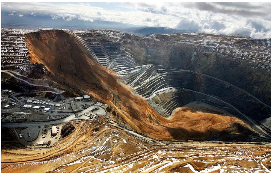
Рис. 4. Гигантский оползень, сошедший 10 апреля 2013 года с борта крупнейшего карьера по добыче медной руды «Бингем» в США [6]
