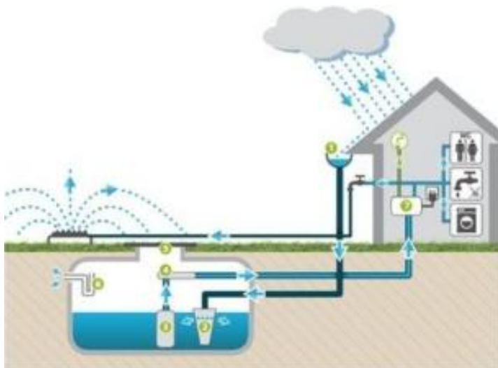
Рис. 6. Схема совместного сбора и очистки дождевых и бытовых сточных вод и их использования для полива газонов в пределах одного коттеджа с участком. Но такие системы могут быть устроены в масштабах целого «города-губки» (newsaler.ru)
