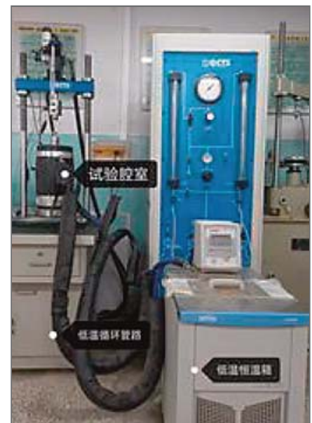
Рис. 9. Внешний вид прибора GCTS STX-100 для динамических испытаний мерзлых грунтов [12]
