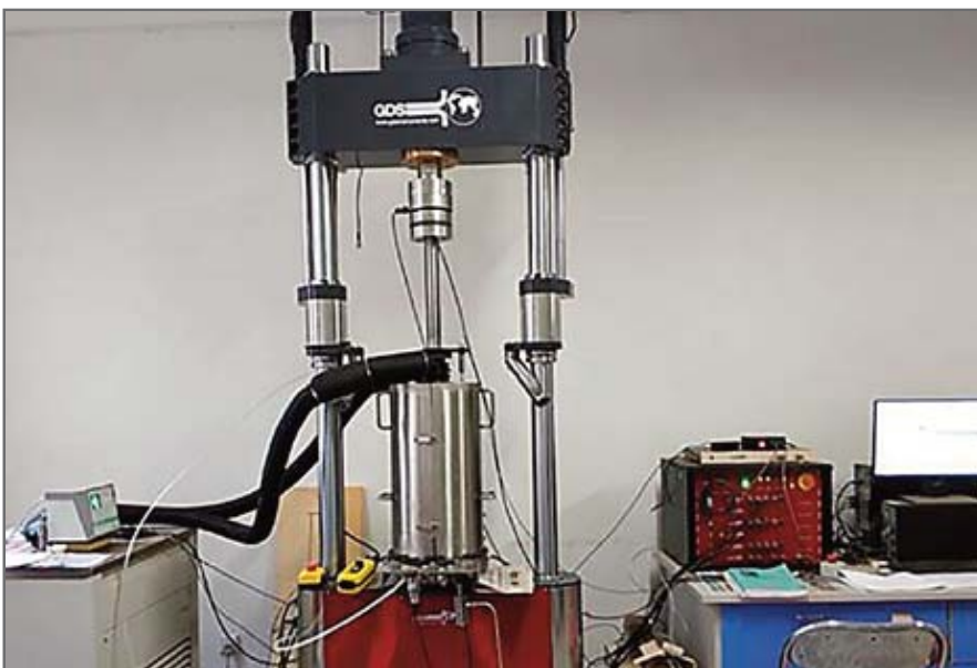
Рис. 8. Установка динамического трехосного сжатия, разработанная компанией GDS для испытаний мерзлых грунтов [11]
