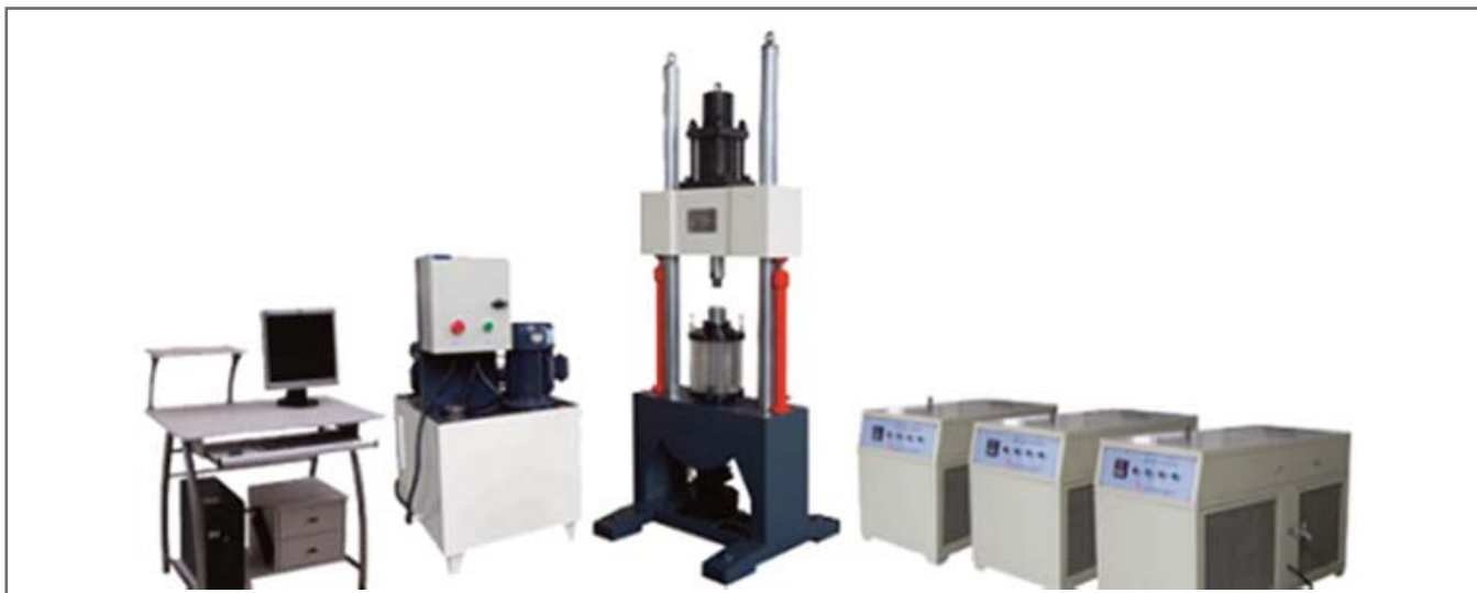
Рис. 10. Внешний вид установки динамического трехосного сжатия TWDSZ300 для испытаний мерзлых грунтов
