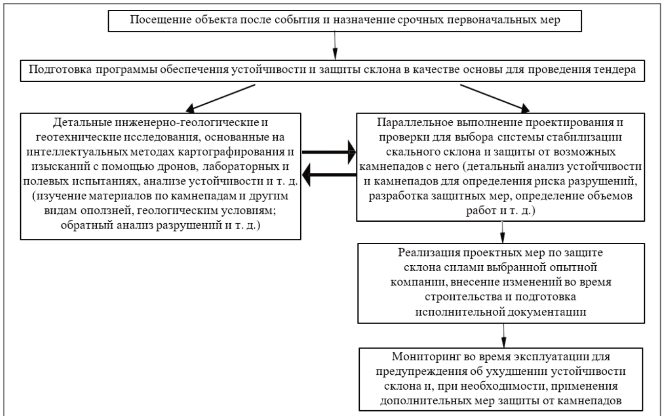
Рис. 1. Блок-схема, иллюстрирующая процесс решения проблем устойчивости склонов в Государственном дорожном управлении Северной Македонии [4]
