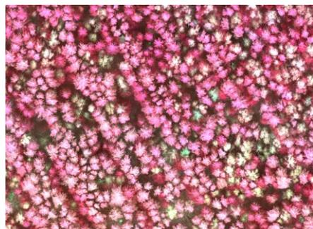
Ортофотоплан 15-20 см/пиксель с Мультиспектральной камеры
